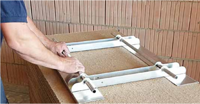
Transporthilfe für Lehmbauplatten
