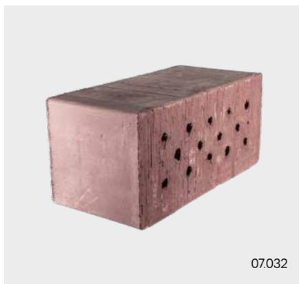
Die Lehmsteine schwer 3DF und 2DF 2000, tragend sind schwere stranggepresste Lehmsteine der Anwendungsklasse II für verkleidetes, witterungsgeschütztes Außenmauerwerk und jede Art von Innenmauerwerk, Lochanteil  $\leq 15\%$ . Sie sind für tragendes Lehmsteinmauerwerk geeignet und erfüllen die Druckfestigkeitsklasse 5 nach DIN 18945. Das Format 3DF erlaubt wirtschaftliches einschaliges Mauern von 17,5 cm und 24 cm dicken Wänden. **Als Mörtel ist ClayTec Lehm-Mauermörtel geeignet.**
