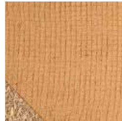
Glasgewebe 112 flächig in Lehmklebe- und Armiermörtel eingearbeitet
