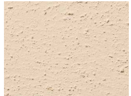
Struktur einer mit Grundierung „DIE GELBE“ vorbereiteten Gipskartonplattenfläche
