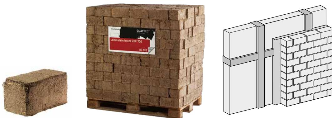
**ClayTec Lehmstein leicht Anwendungsklasse II** ist ein besonders leichter Lehmstein der Anwendungsklasse II (= für Innenmauerwerk) mit wärmedämmender Wirkung. Der Lehmstein 700 2DF ermöglicht die moderate Innendämmung von Fachwerkhäusern und allen anderen Altbauten in üblicher Mauerwerkstechnik. Als Mörtel ist Lehm-Mauermörtel leicht geeignet.
