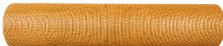
Flächenarmierung für Lehmklebe- und Armierungsmörtel und alle Lehmputze. CLAYTEC-Glasgewebe ist ein Drehergewebe aus Glasseidengarn/Roving, appretiert mit Polymerausrüstung. Es ist zugfest, sehr fein und besonders gut zu verarbeiten.
