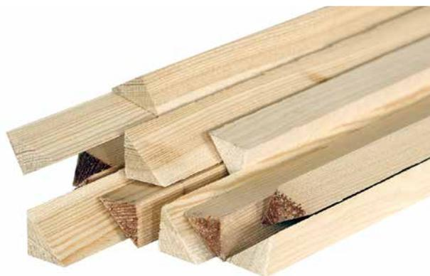
**Lärchen- oder Eichenholzleisten** für die Verbindung zwischen Mauerwerk und Fachwerkbalken. Der Querschnitt ist auch für alte unregelmäßige Balken ausreichend biegsam und anpassungsfähig. Die Höhe entspricht der Dicke der gefachabschließenden Lehmörtelfuge. Lärchenholz ist stabil, beständig und sehr gut zu nageln. Dreieckleisten aus Eiche sind für Fachwerkhäuser aus Eichenholz sehr denkmalgerecht.
