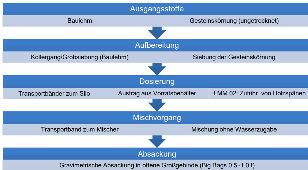
Bild 4.1 Produktionsschema für LMM 01 „schwer“ und LMM 02 „leicht“, Erdfeuchtverfahren
