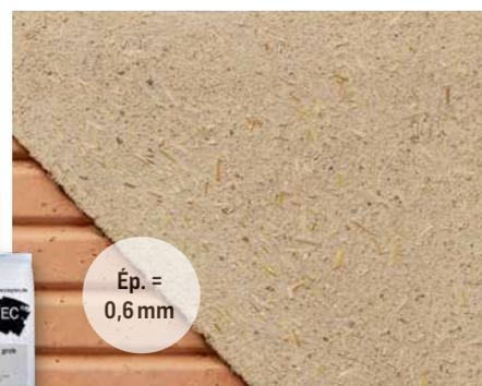
Enduit d'argile de finition grossier CLAIR sur de la maçonnerie
