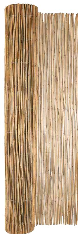
Support pour plafonnages sur supports mixtes et bois. La toile en roseaux et fils métalliques comportant 70 tiges/ml a été redécouverte et développée dans les années 1980 par CLAYTEC. Les écart entre les tiges correspondent parfaitement au grain des enduits d'argile grossiers. Elle assure l'adhérence de l'enduit sur les poutres en bois et offre de la solidité aux murs instables et couches de charges épaisses.
