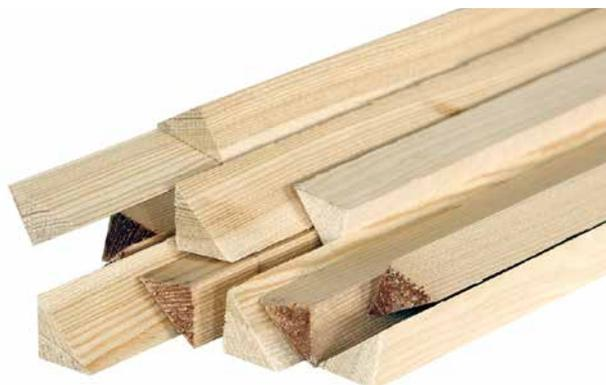
Lattes en bois de mélèze ou chêne pour les raccords entre la maçonnerie et les poutres des colombages. La section est suffisamment souple et adaptable, même pour les poutres anciennes irrégulières. La hauteur correspond à l'épaisseur du joint de mortier d'argile en limite de compartiment. Le bois de mélèze est robuste, résistant et facile à pointer. Les lattes triangulaires en chêne sont très respectueuses du patrimoine pour les maisons à colombages en chêne.
