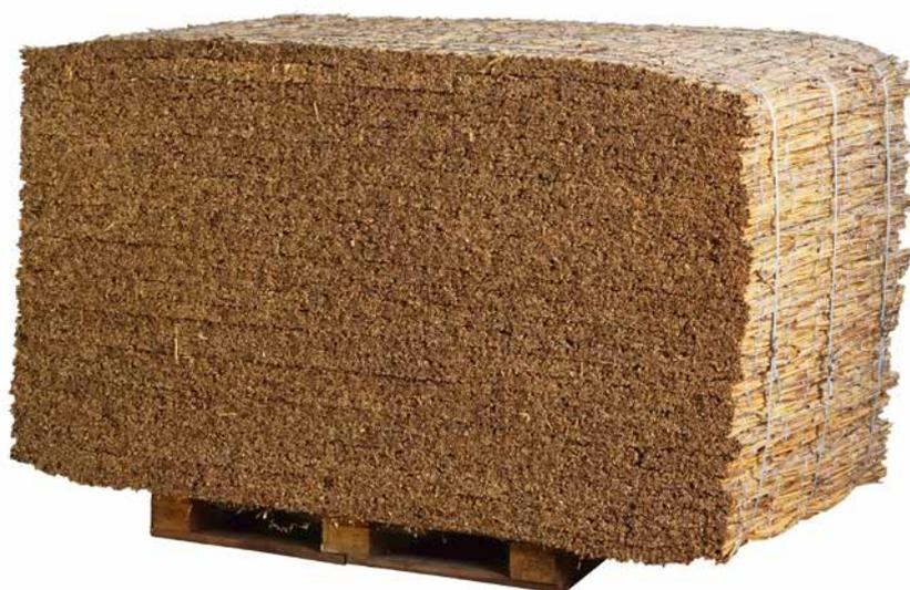
Panneau de construction en tissé de roseaux pour cloisons intérieures et pour l'amélioration de l'isolation thermique et de la température de surface des murs extérieurs. Le produit isolant naturel traditionnel est utilisé depuis de nombreuses années pour les isolations intérieures simples. Ses caractéristiques et qualités de matériau conviennent particulièrement bien pour les chantiers sur les bâtiments classés.
