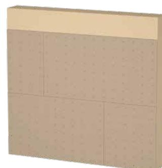
Panneau en fibre de bois fin (HFA) comme support pour plafonnages sur le bois et les matériaux à base de bois. Les panneaux peuvent être vissés ou agrafés. Sur le bois, on obtient ainsi facilement un support très fiable pour la couche d'armature en mortier d'adhérence et la couche de finition d'argile consécutive.
