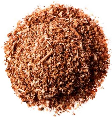
Granulés secs et coulants pour plafonds Les granulés d'argile bois légers se composent d'argile et d'un important volume de copeaux de résineux.
