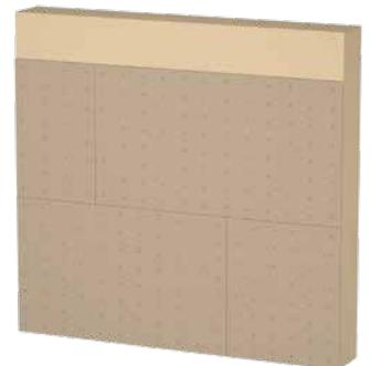
Dünne Holzfaserausbauplatte (HFA) als Putzträger auf Holz- und Holzwerkstoffen. Die Platten können geschraubt oder geklammert werden. So entsteht auf Holz sehr einfach ein sicherer Untergrund für die Armierungslage aus Lehmklebe- und Armierungsmörtel und das nachfolgende Lehm-Finish.
