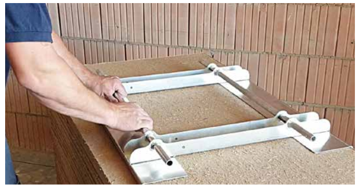
Transporthilfe für Lehmbauplatten
