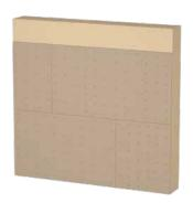
Dünne Holzfaserausbauplatte (HFA) als Putzträger auf Holz- und Holzwerkstoffen. Die Platten können geschraubt oder geklammert werden. So entsteht auf Holz sehr einfach ein sicherer Untergrund für die Armierungslage aus Lehmklebe- und Armiermörtel und das nachfolgende Lehm-Finish. Ergänzend zu diesem Produktblatt gilt der ClayTec Leitfaden ökologische Trockenbauwände im System.
